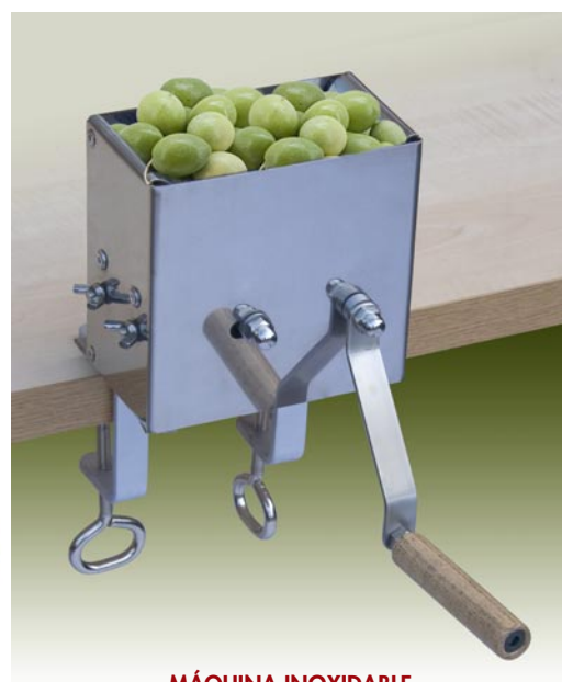
MÁQUINA INOXIDABLE DE RAJAR ACEITUNAS CON SOPORTE (CUCHILLAS INOXIDABLES)
